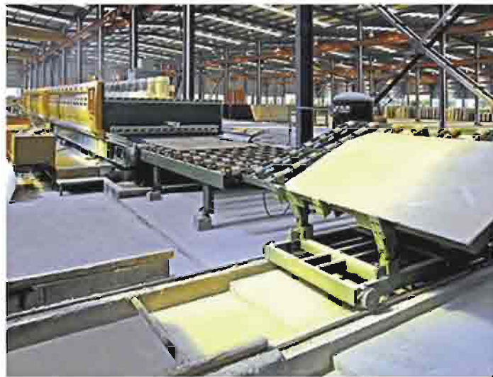
意大利连续抛磨机 Italian automatic polishing machine
