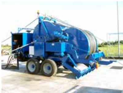
El "Concepto de Máquina Doble" tanto para las operaciones de tendido aéreo como de tendido subterráneo
