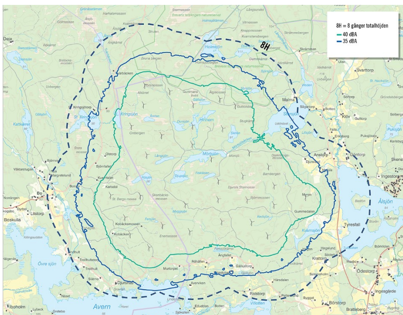
Figur 2.2 Principskiss: Åtta gånger totalhöjden (8H) och ljudutbredningen för en vindkraftspark
