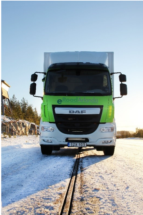
Figur 3.8 Elways nedsänkta skena med lastbil
