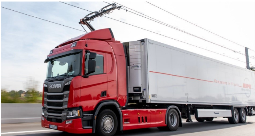
Figur 3.6 Siemens luftledningar med lastbil
