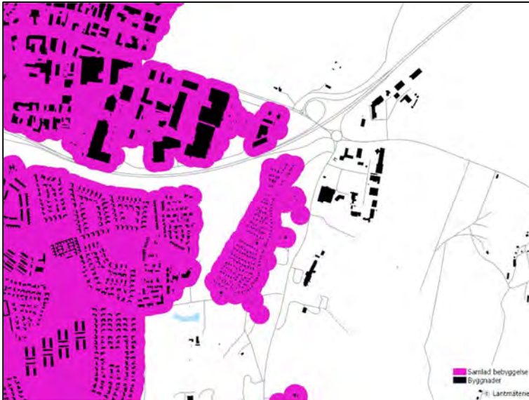
Figur 16: Exempel från handelsområde vid Hällamotet i Västerås. I detta exempel har avståndet 50 m använts för samtliga byggnadstyper.
