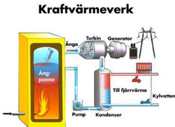
Figur 5.1 Principiell skiss av ett kraftvärmeverk
