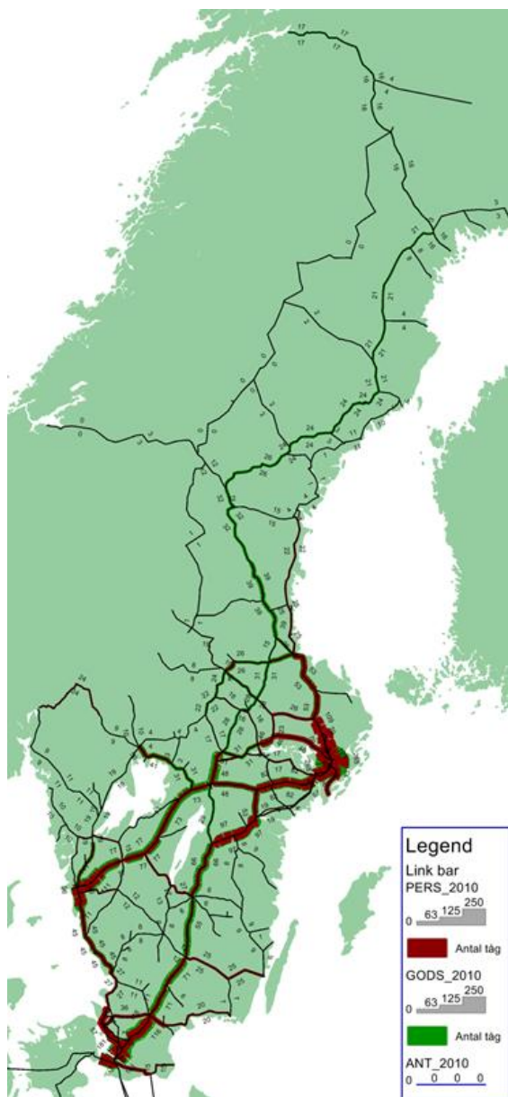
Figur 7.8 Totalt antal tåg per länk och riktning för järnvägsnätet i Sverige 2010. Rött är persontåg och grönt är godståg som ligger utanpå persontågen. Den totala bandbredden motsvarar således det totala antalet tåg
