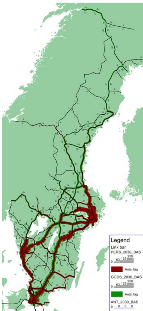
Figur 7.9 Totalt antal tåg per länk och riktning för järnvägsnätet i Sverige med prognos för basalternativet 2030. Rött är persontåg och grönt är godståg som ligger utanpå persontågen. Den totala bandbredden motsvarar således det totala antalet tåg
