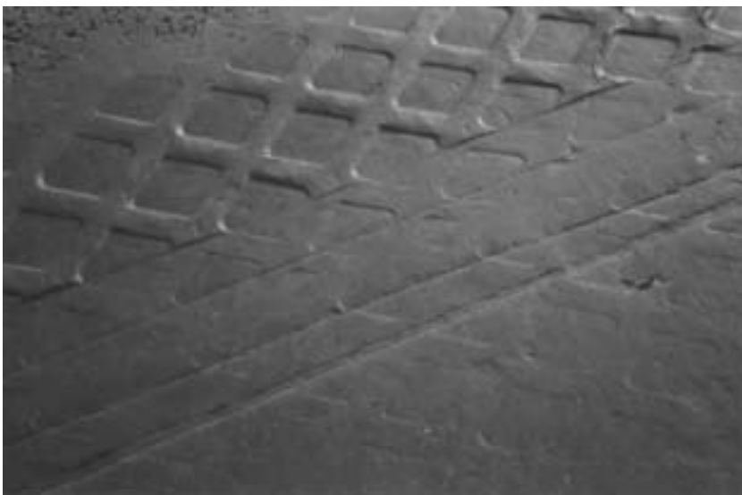
Figur 11 Homogen struktur hos kompakterad Friedland Ton
