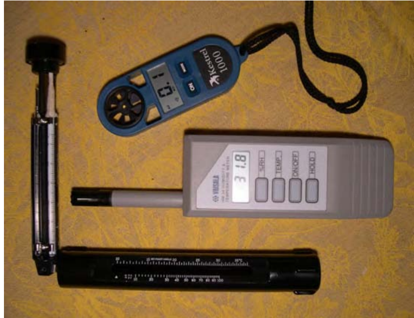
Figur 25 Instrument för fältobservation av vädervariabler som är viktiga för brandbeteende. Nederst en psykrometer för mätning av relativ luftfuktighet. Den har två termometrar varav en har spetsen täckt av en fuktig strumpa. Instrumentet snurras någon minut och temperaturdifferensen mellan torr och våt temperatur översätts till rh via en "räknesticka" på handtaget. Ett alternativ till psykrometern är elektroniska instrument av god kvalitet. Överst en liten handhållen vindmätare.
