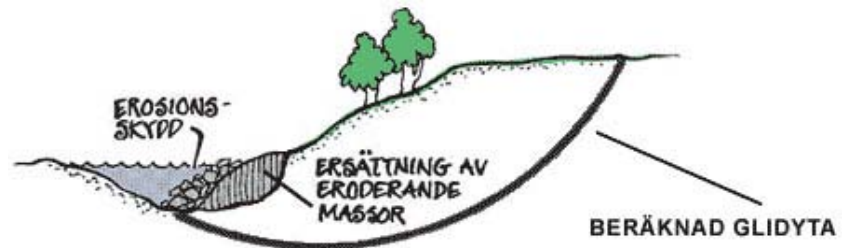
Figur 6.5 Återställning av slänt och utläggning av erosionsskydd. (Skredkommissionen Rapport 5:95)
