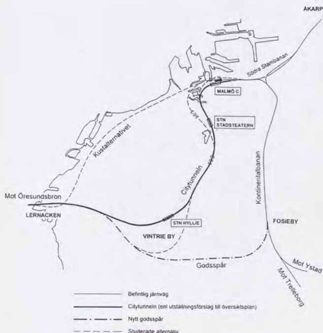
Figur 2.5 Tidigare studerade alternativa sträckningar för en järnvägstunnel genom Malmö.
