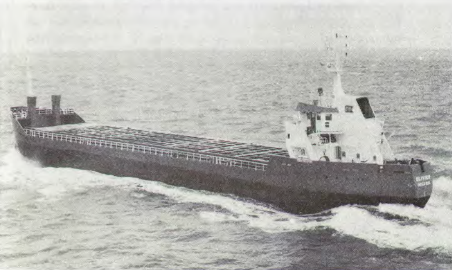
Bild 6 M/s Olivier. Bulkfartyg för bl.a. malmtransporter, lastförmåga i Vänern 3 900 ton. Fartyget går bl.a. i systemtrafik med malmkoncentrat mellan Otterbäcken och Belgien.
