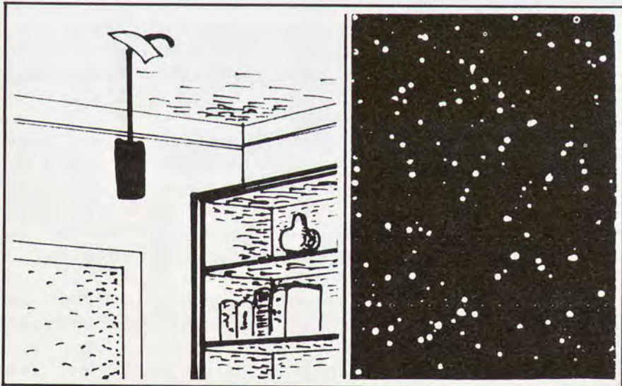
Det är lätt och billigt att mäta radonförekomsten. Till vänster syns uppsatt radonmätare och till höger syns mätfilmens utseende.
