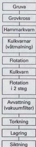
Figur 18:1 Grafitproduktion, typiskt flytschema för tillverkning av flinggrafit i Kina
