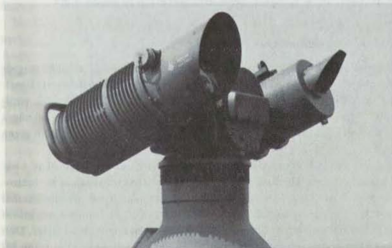
Avståndsmätande laser för luftvärnssystem, här tillsammans med en TV-kamera för följning av ett mål.
