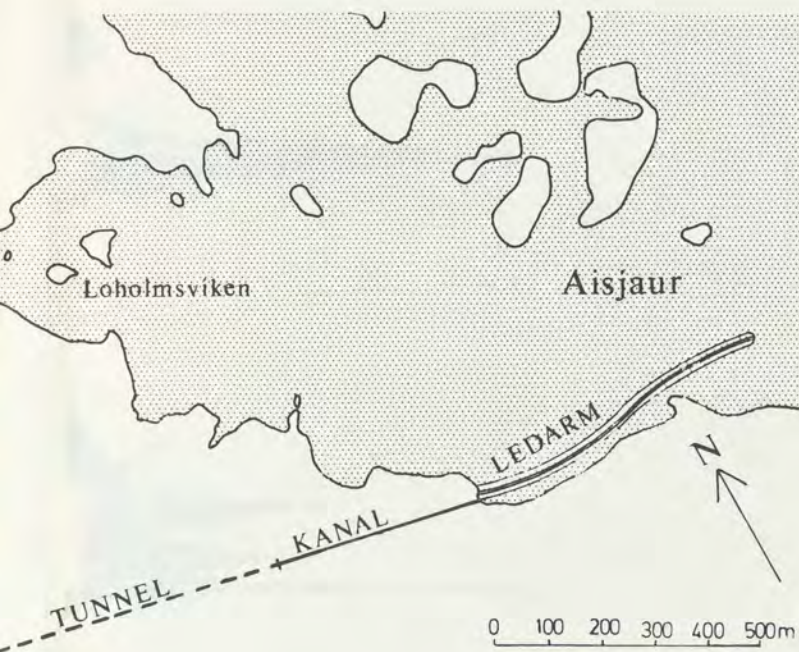
Figur 2.11 Utloppet i Aisjaur med tunnel, kanal och ledarm.
