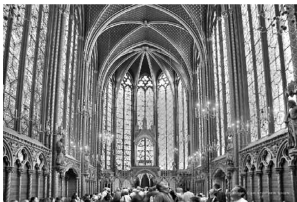
Figura 37. Espacio gótico en la Edad Media. La luz diáfana e inmaterial (sobrenatural) es la que lo define. La complejidad de la tecnología de la piedra superpuesta, sin amarres, se resuelve en el exterior con los contrafuertes y arbotantes.
