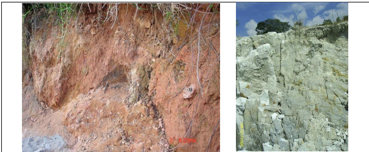
Figura 2o. Formación Casabianca: aunque la clasificación da esta unidad como roca Clase V, realmente debería calificarse Clase VI. Esta imagen muestra un estado más alterado de lo que se espera de esta unidad. A la izquierda, afloramiento en Villa Carmenza Casabianca donde muestra un suelo residual que ilustra bien su origen conglomerático. A la derecha, los suelos blancos expansivos en el sector de San Rafael.
