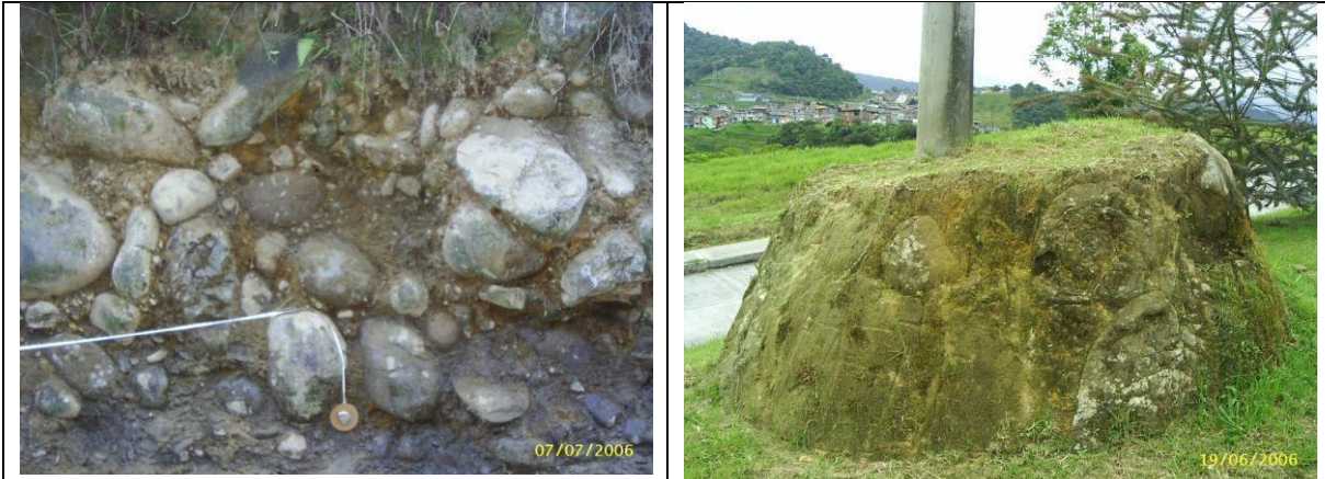
Imagen 1j. Formación Manizales en la panamericana (Izq) y Formación Casabianca en Santa Helena (Der). Además del fuerte contraste en el grado de meteorización entre ambas, el color de la matriz, café en la primera y naranja o rojizo en la segunda, facilitan su diferenciación.
