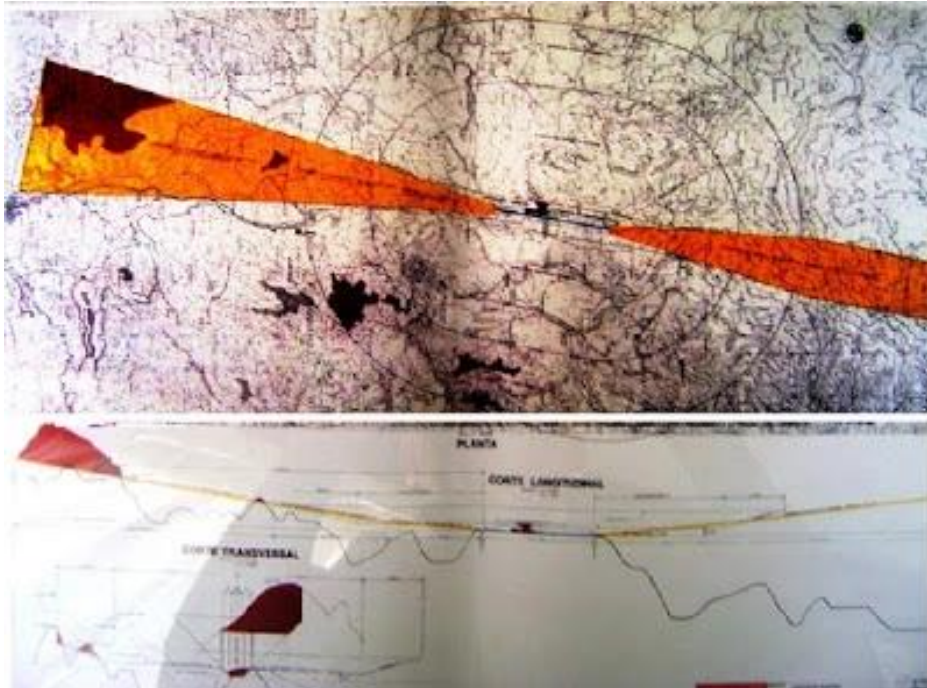
Aeropuerto del Café: Interferencias en Conos y Anillo de aproximación. Imágenes de HJ ROSS 2002.
