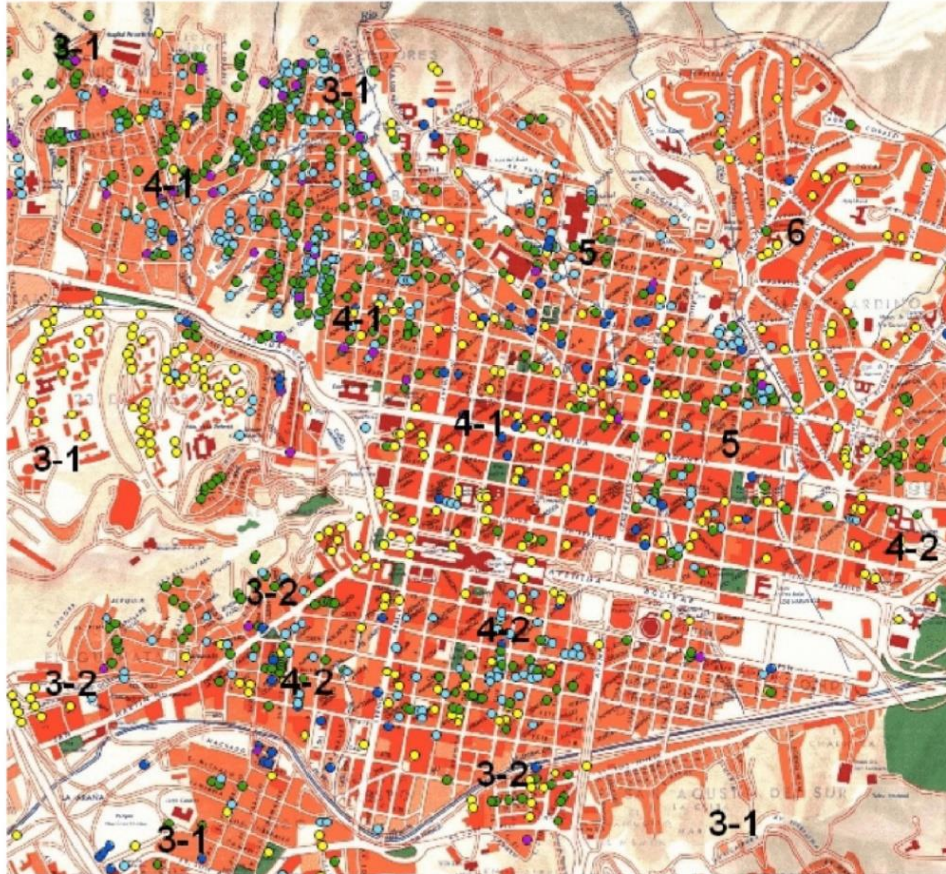
Figura 6. Daños estructurales en el terremoto de 1967. Los círculos rojos indican edificios de difícil reparación; los círculos morados, casas de difícil reparación; los azules, edificios con daños moderados; los turquesa, casas con daños moderados; los amarillos, edificios con daños menores; verdes, casas con daños menores. Fuente: Detalle del plano elaborado por Funvisis, 2009
