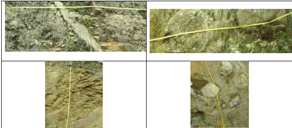
Figura 11. Imágenes para la valoración de la calidad de la roca para el Complejo Quebradagrande, en el sector de La Sultana (Izq) y para la Formación Casabianca en el sector de Santa Helena (Der). Sobre taludes donde afloran ambas formaciones se han estimado estos valores del RQD en 30% y 6%, respectivamente.
