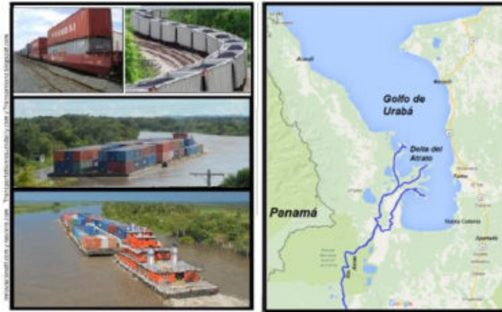
Imagen 4.28. Izq. Un sistema fluvial en tren de doble aparejo para 620 TEU, podría resultar lento para remontar el Magdalena, y muy largo para transitar una corriente de pronunciados y frecuentes meandros. Imágenes Unipymes y PDP-MC. Der: Golfo de Urabá y Delta del Atrato, ubicados en la mejor esquina de América, con un sistema portuario en desarrollo. Fuente Google Earth adaptado.
