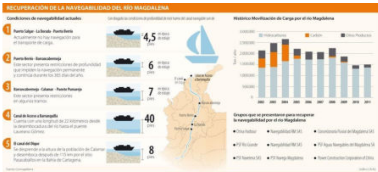
Imagen 4.38. Profundidad de dragado para el canal navegable y Carga por el río Magdalena, mostrando el protagonismo de los hidrocarburos y el carbón. Fuente, Cormagdalena. Mayor información en: Cuenca alta de Yuma, el Río Grande de Colombia.
