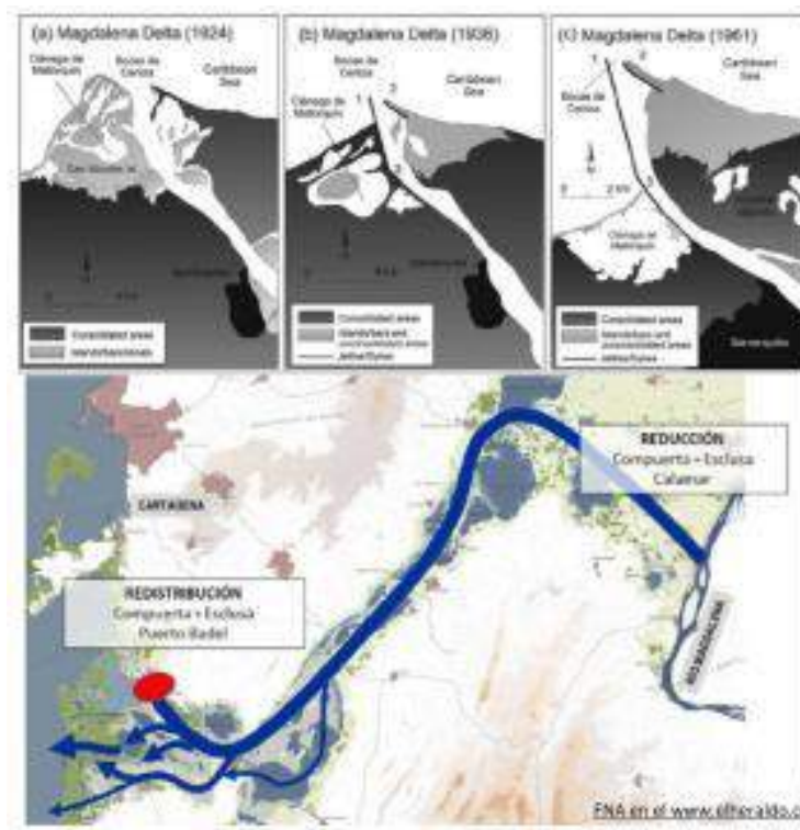
Imagen4: Arriba: cambios en el Delta del Magdalena 1924-36-61 ( www.researchgate.net ). Abajo: Canal del Dique: esclusas y 6 pies para su navegabilidad (ANI- El Heraldo)
