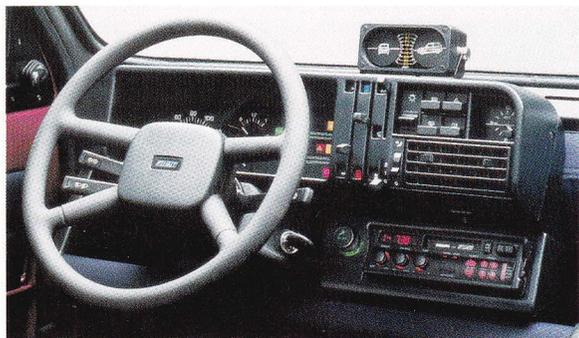
*Tableau de bord avec inclinomètre latéral et longitudinal (Panda 4x4 1100 i.e. S).*
