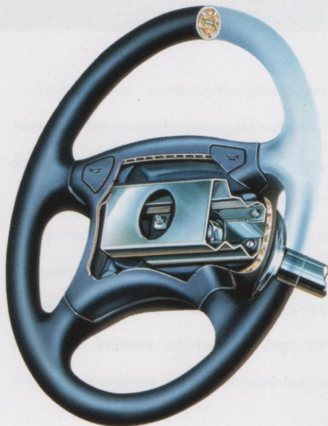
Volant type E.A.S. équipé d'un moyeu à absorption d'énergie.
