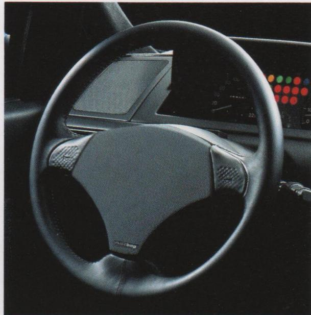
L'Airbag Fiat®\* et les ceintures de sécurité avant avec prétensionneur : une protection optimale pour le conducteur en cas de choc frontal (volant gainé cuir disponible avec l'option intérieur cuir).
