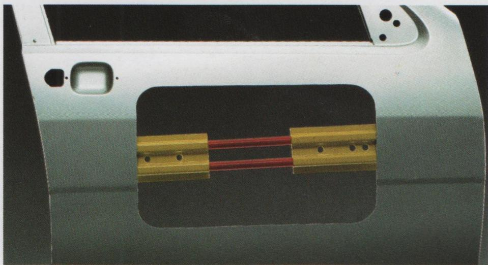
Les traverses de renfort en acier, intégrées dans les portes assurent une protection accrue en cas de choc latéral et contribuent à améliorer la résistance de la structure en cas de collision frontale ou arrière.
