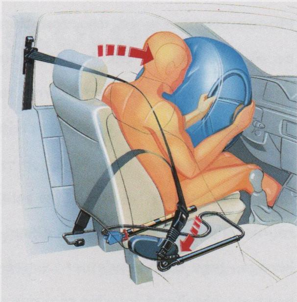
secondes, protégeant ainsi la tête et le buste du conducteur. Dans le même temps, le prétensionneur annule le jeu des ceintures, en plaquant le conducteur et le passager contre leur dossier en leur imprimant une force de décélération plus graduelle.
