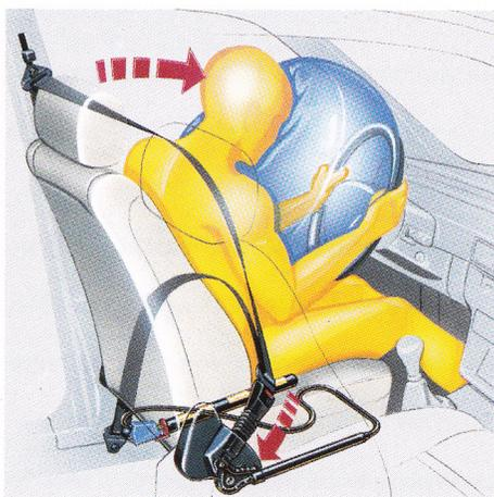
de seconde, protégeant ainsi la tête et le buste du conducteur. Dans le même temps, le prétensionneur annule le jeu des ceintures, en plaquant le conducteur et le passager contre leur dossier en leur imprimant une force de décélération plus graduelle.
