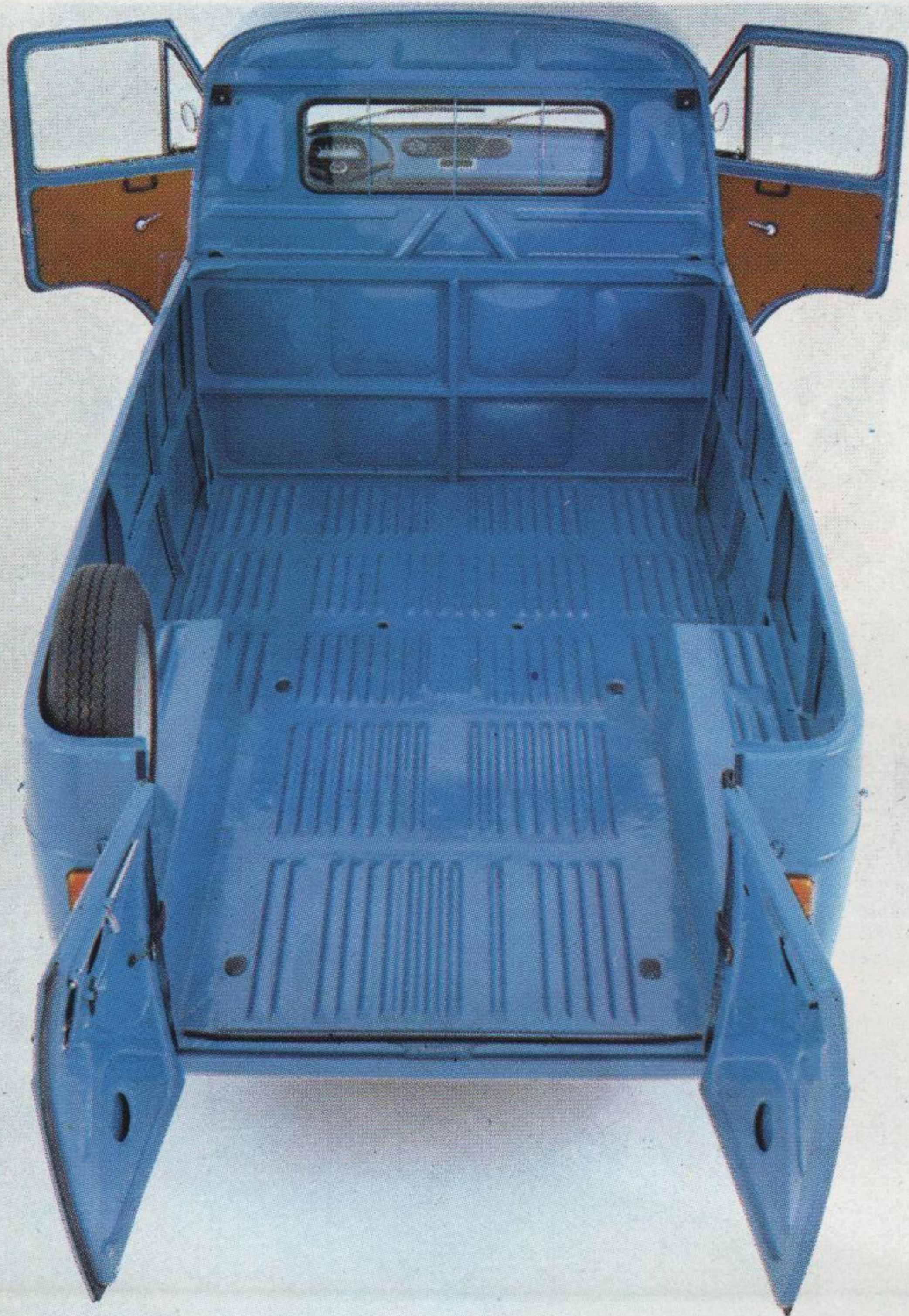
Fiat 238 fourgon vitré. Surface utile 3,4 m 2 . Volume 6,5 m 3 . Charge utile 1000 kg.
