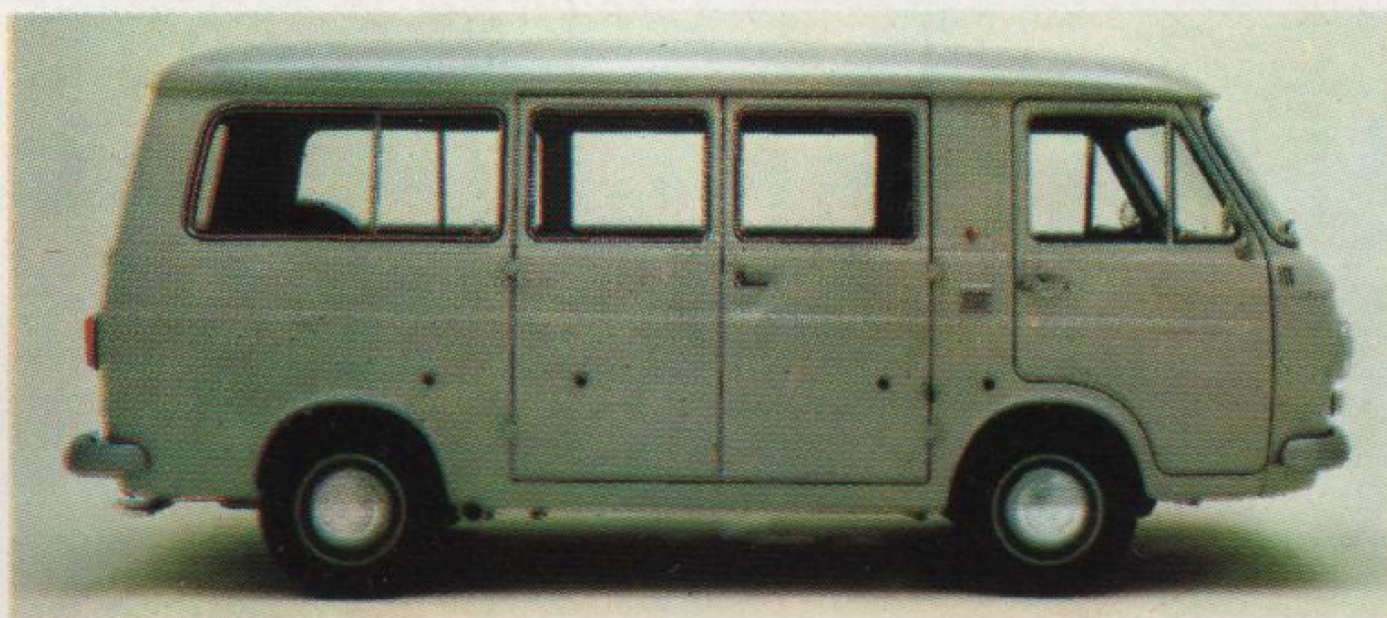
Fiat 238 fourgon vitré. Surface utile 3,4 m 2 . Volume 6,5 m 3 . Charge utile 1000 kg.
