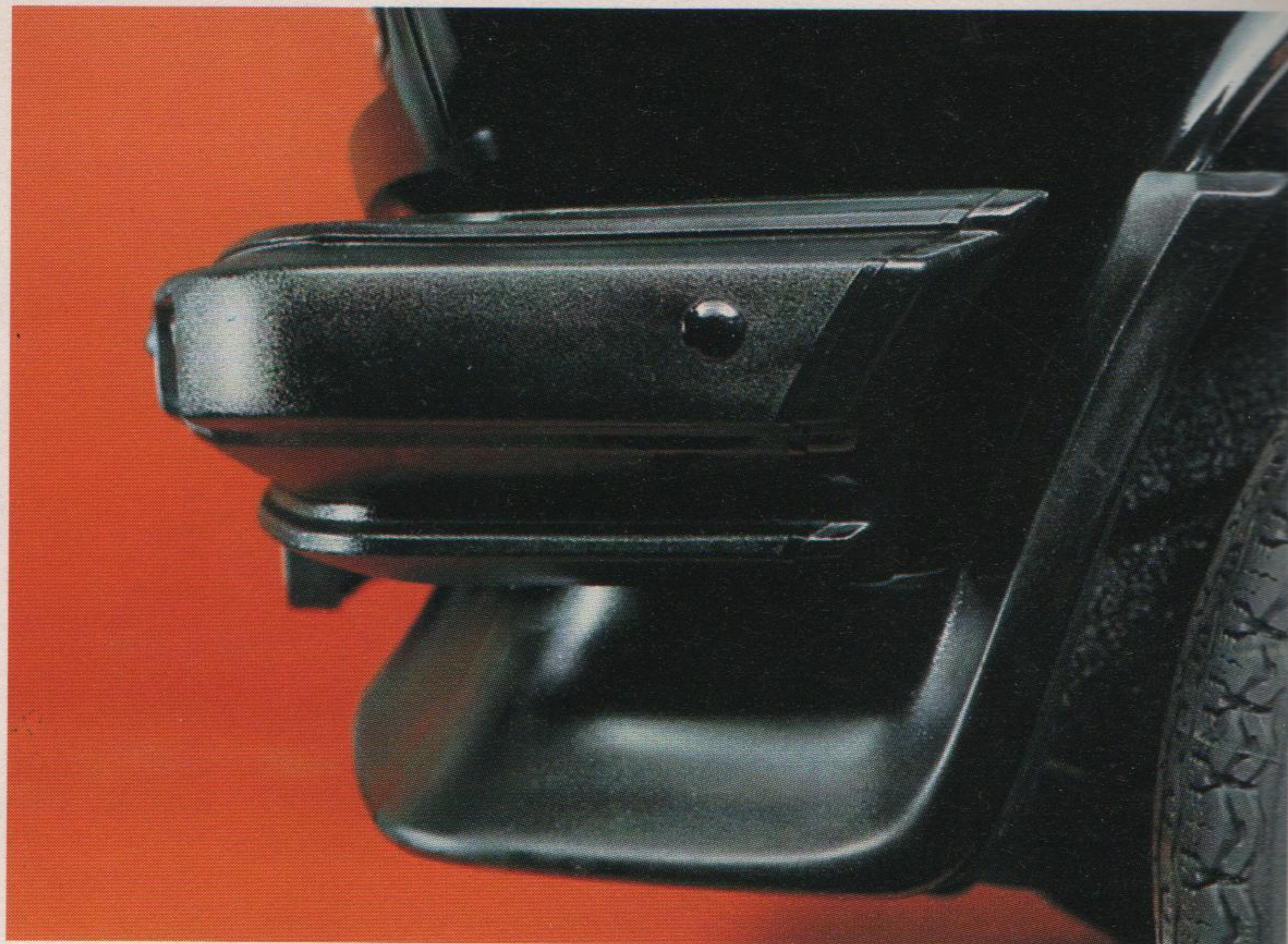
Le spoiler avant : il augmente l'adhérence aux vitesses élevées
