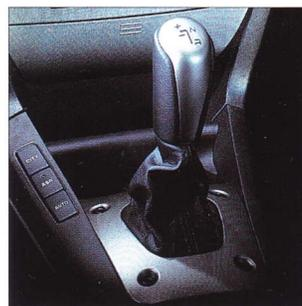
*Avec la boîte séquentielle Selespeed, le changement manuel des vitesses peut s'exécuter de 2 façons : soit par une levier "traditionnel" situé sur la console, soit grâce à des palettes situées derrière le volant, comme sur une Formule 1.*
