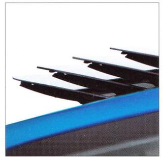
Pour vous permettre de ressentir les sensations procurées par un cabriolet, Fiat Stilo vous propose (en option) le toit ouvrant à ciel ouvert "Sky Window". Quelques secondes suffisent pour que ses cinq lamelles en verre Sécurité libèrent jusqu'à 1 mètre carré de ciel ! Pour votre confort, ce toit ouvrant est équipé d'une jalousie électrique et pour votre sécurité, d'une fonction anti-pincement. ■
