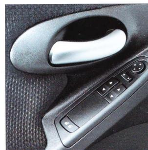
*Commandes des lève-vitres avant électriques et des rétroviseurs électriques et chauffants (de série).*
