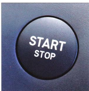
*Grâce au système d'identification du conducteur "Easy Go" (en option), plus de clé, ni pour ouvrir, ni pour fermer les portes. Pour démarrer, plus de clé non plus : il vous suffit d'appuyer sur le bouton "Start" et, simultanément, sur la pédale d'embrayage ou de frein.*
