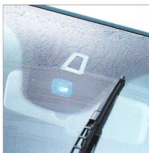
*Le capteur de pluie déclenche et régule automatiquement les essuie-glaces en fonction de la force de l'averse (de série ou en option selon les versions et les finitions).*
