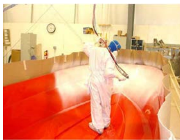
2. Applicazione dello strato protettivo
