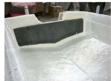
3. Applicazione delle fibre di vetro nello stampo
