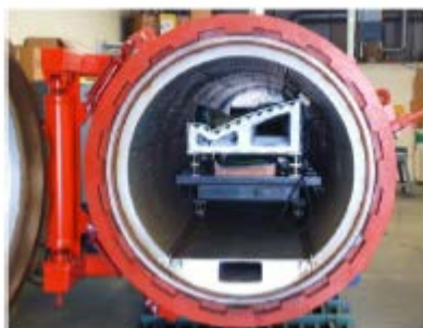
Autoclave caricata con il pezzo sopra il tool
