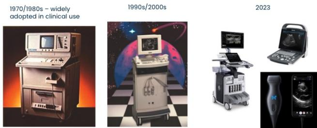
Man mano, si passa a configurazioni sempre più leggere fino a diventare portatili e utilizzabili con il cellulare per casi di emergenza. Rimangono sempre gli elementi base: sonda e dispositivo di visualizzazione.
