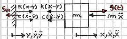
$$\begin{cases} m\ddot{x} + c(\dot{x} - \dot{y}) + k(x - y) = F \\ c(\dot{x} - \dot{y}) + k(x - y) = F_{TR} \end{cases} : \text{MOTION EQS}$$
