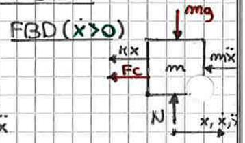
$m\ddot{x} + Kx = \pm F_c = \pm f_d N$  : NON LINEAR  $\rightarrow$  "PIECEWISE LINEAR SYSTEM"
