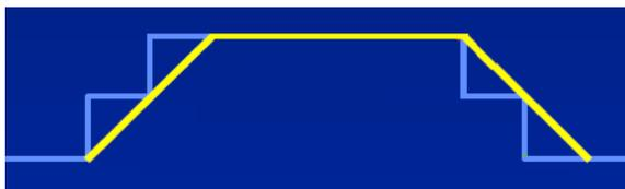
Facendo così non solo si riduce di molto la coppia indesiderata (*cogging torque*), ma si trasformano anche le gradinate della funzione  $F(\alpha)$  in pendenze continue per ottenere l’onda trapezia desiderata. Nello stesso tempo però l’operazione di *skewing* richiede una lunghezza di conduttore maggiore di quanto è strettamente necessario.
