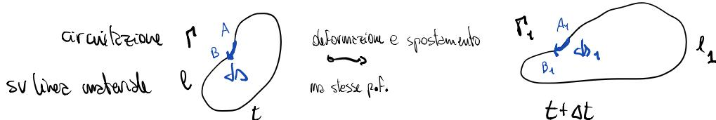
$$\frac{D\Gamma}{Dt} = \lim_{\Delta t \rightarrow 0} \frac{\Gamma_1 - \Gamma}{\Delta t} \quad \text{con} \quad \Gamma_1 = \oint_{l_1} \vec{v} \cdot d\vec{s} \quad \text{e} \quad \Gamma = \oint_l \vec{v} \cdot d\vec{s} \quad \Rightarrow$$
