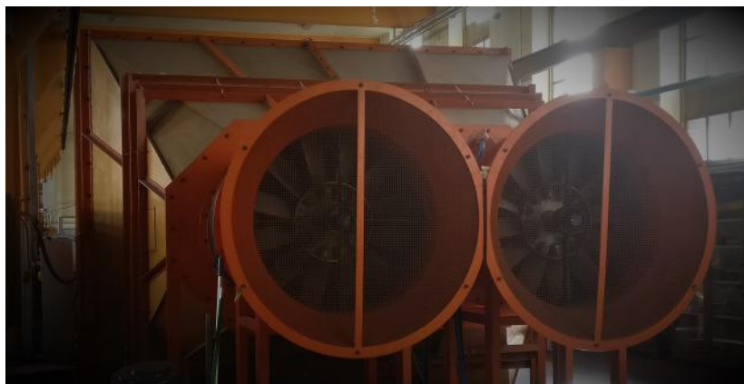
Figura 7.2: Motori della galleria del vento utilizzata con dietro la camera di tranquillizzazione del flusso
