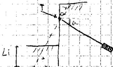
L'angolo di inclinazione  $\alpha$  del tirante è una scelta progettuale. Solitamente  $\alpha = 10^\circ - 20^\circ$ . Il punto di applicazione  $O$  del tirante è una scelta progettuale
