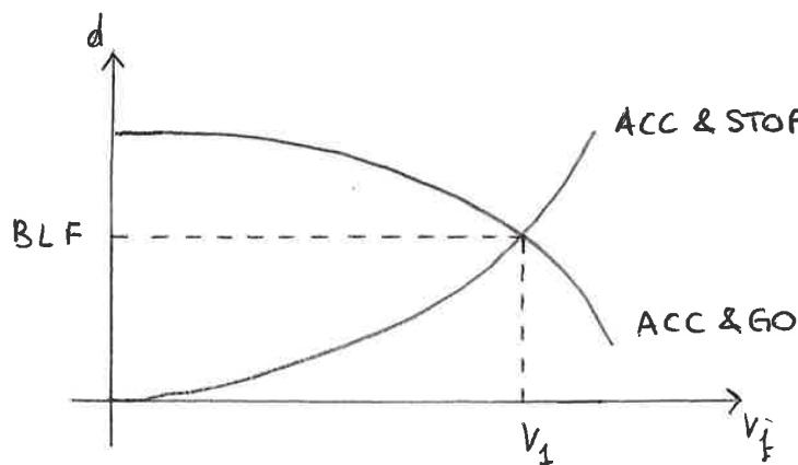
**BLF** (= Balanced Field length) è la distanza corrispondente alla velocità di decalage  $v_1$ , che definisce il confine tra le due situazioni ACC & GO e ACC & STOP.
