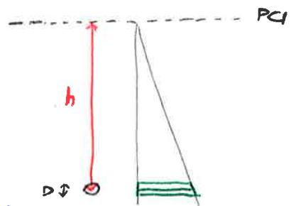
$$\begin{aligned} P_{\text{nuova}} &= \delta \cdot h \\ \Delta p = P_{\text{nuova}} - P_{\text{iniziale}} &= \delta \cdot D \\ &= \delta \cdot D \end{aligned}$$
