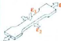
Trazionando una provetta di lamiera e misurando separatamente in vari step le deformazioni nelle tre direzioni principali, si nota che il rapporto
