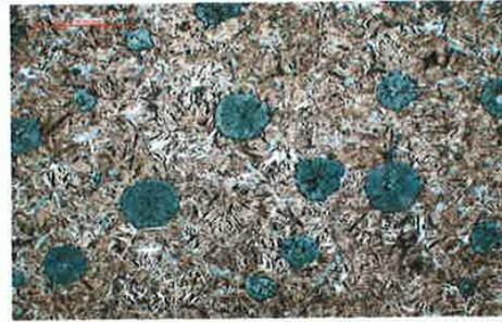
La struttura è tipicamente martensitica. Questo materiale ha una buona resistenza a fatica (ghisa sferoidale) e soprattutto all'usura (utilizzato per le camme di alberi distribuzione).
