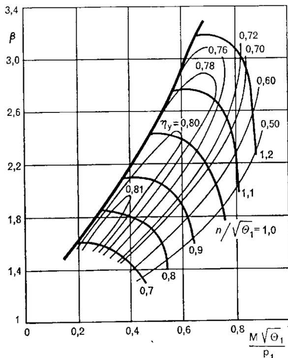
5) Un compressore centrifugo presenta la caratteristica in figura e lavora in progetto nel punto A ( $p_1 = p_0 = 102$  kPa,  $T_1 = T_0 = 288$  K). Determinare la potenza assorbita dal compressore ( $\eta_m = 0.95$ ) e la temperature di mandata dell'aria.
