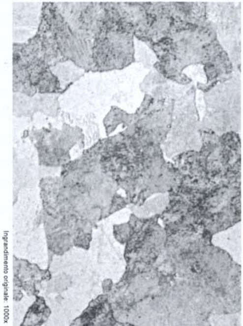
Acciaio \approx 0.4\% \text{ C} , legato Perlite fine (microscopio ottico)
