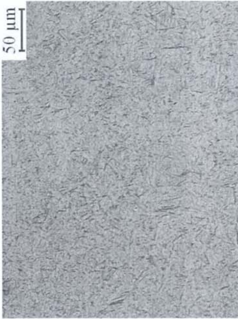
Acciaio 40CrMnNiMo8-6-4 temprato, attacco Nital
