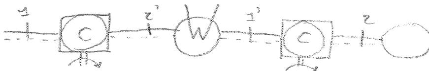
Nel caso di compressione, il lavoro minimo si ha per una trasformazione isoterma: mi voglio riportare alla  $T$  iniziale di compressione  $T_1' = T_1$
