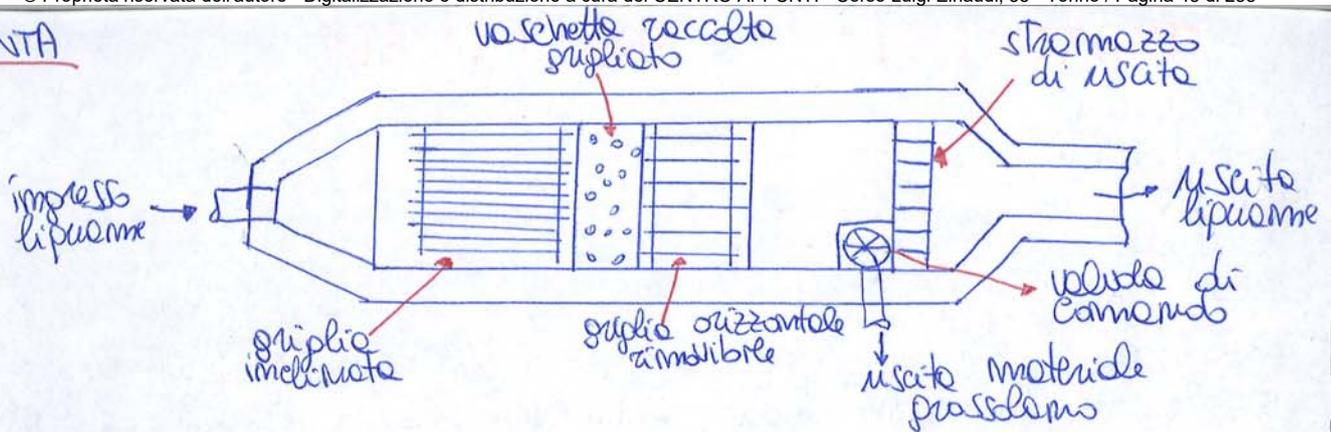
de grigliature è la prima dei trattamenti meccanici preliminari e ha come scopo principale la rimozione di corpi e oggetti grossolani; permette di evitare danneggiamenti alle sezioni di impianto successive, ed esempio le pompe usate per spostare e sollevare il lipuame, e ridurre l'accumulo di solidi nelle tubazioni.
