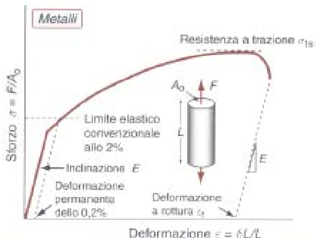
Curva sforzo-deformazione per un metallo.
