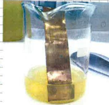
Lamina di Cu immersa in  $FeSO_4$
