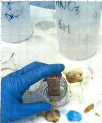
Ponendo la lamina di Cu nella soluzione di  $H_2SO_4$  notiamo che non ci sono cambiamenti.
