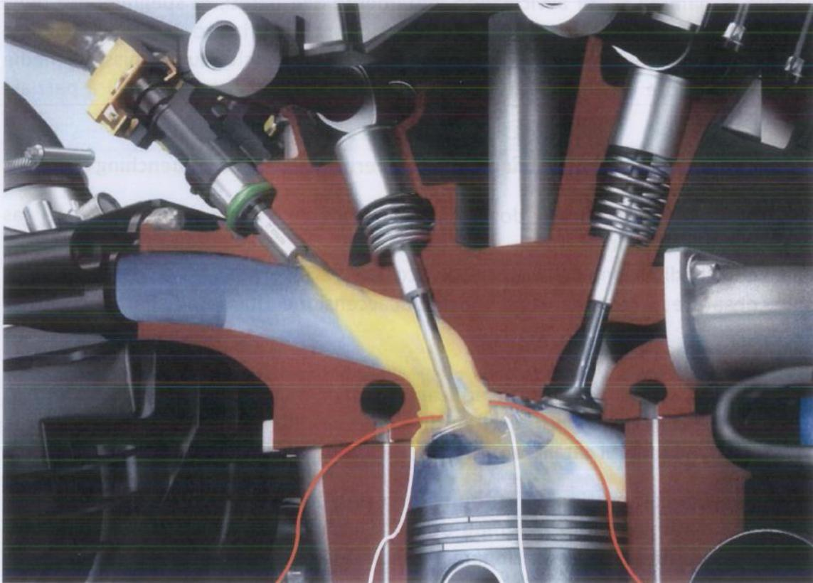
Trasferimento di calore dalla valvola di aspirazione. Questo viene in parte trasferito al combustibile che dopo l'iniezione si è accumulato sulla testa della valvola.
