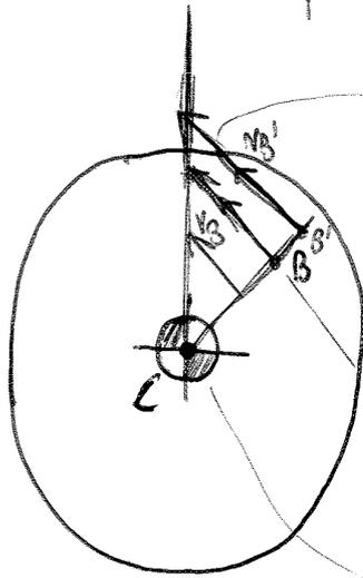
Il modulo delle velocità di B dipende dalle distanze da C
