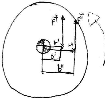
Il senso  $\alpha$  si determina con le regole della mano destra
