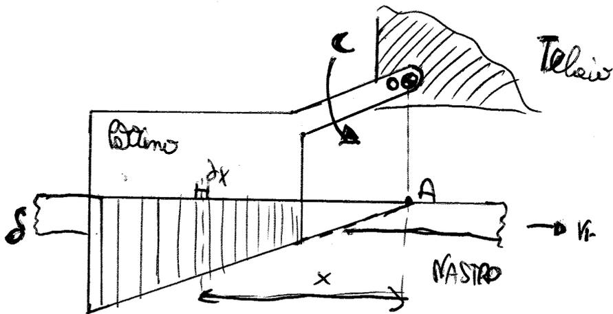
Il pattino è incernierato ad un telaio fisso, e viene premuto per frenare il moto di un nastro.
