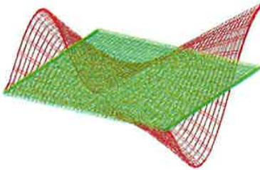
**Figura 5.6:** modo 5: torsionale a due semionde
