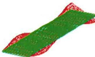
**Figura 2.26: modo 10:** torsionale a tre semionde
