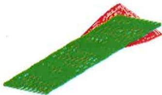
**Fig. 2.23: modo 7:** torsionale a due semionde
