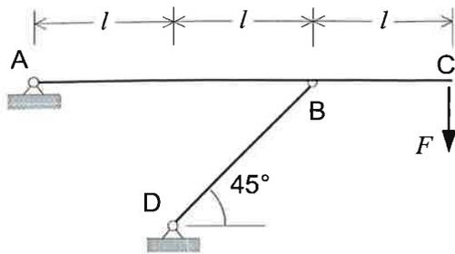
4) Calcolare tutte le reazioni vincolari (interne ed esterne) della struttura schematizzata in figura.
