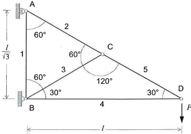
1) Dopo avere determinato le reazioni vincolari esterne, costruire per ogni nodo il corrispondente poligono delle forze e calcolare le forze normali in tutte le aste della struttura reticolare illustrata nella figura.
