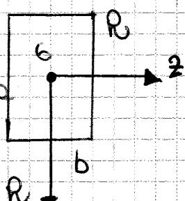
Momento d'inerzia della sezione rispetto ad un asse che giace sul piano della sezione I alla dist. del carico
