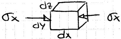
quando definisco il "TENSORE delle TEMSIOMI" di un elemento infinitesimo, questo presiede da tutto quello che c'è a livello (modello scelto, tipo di carico)
